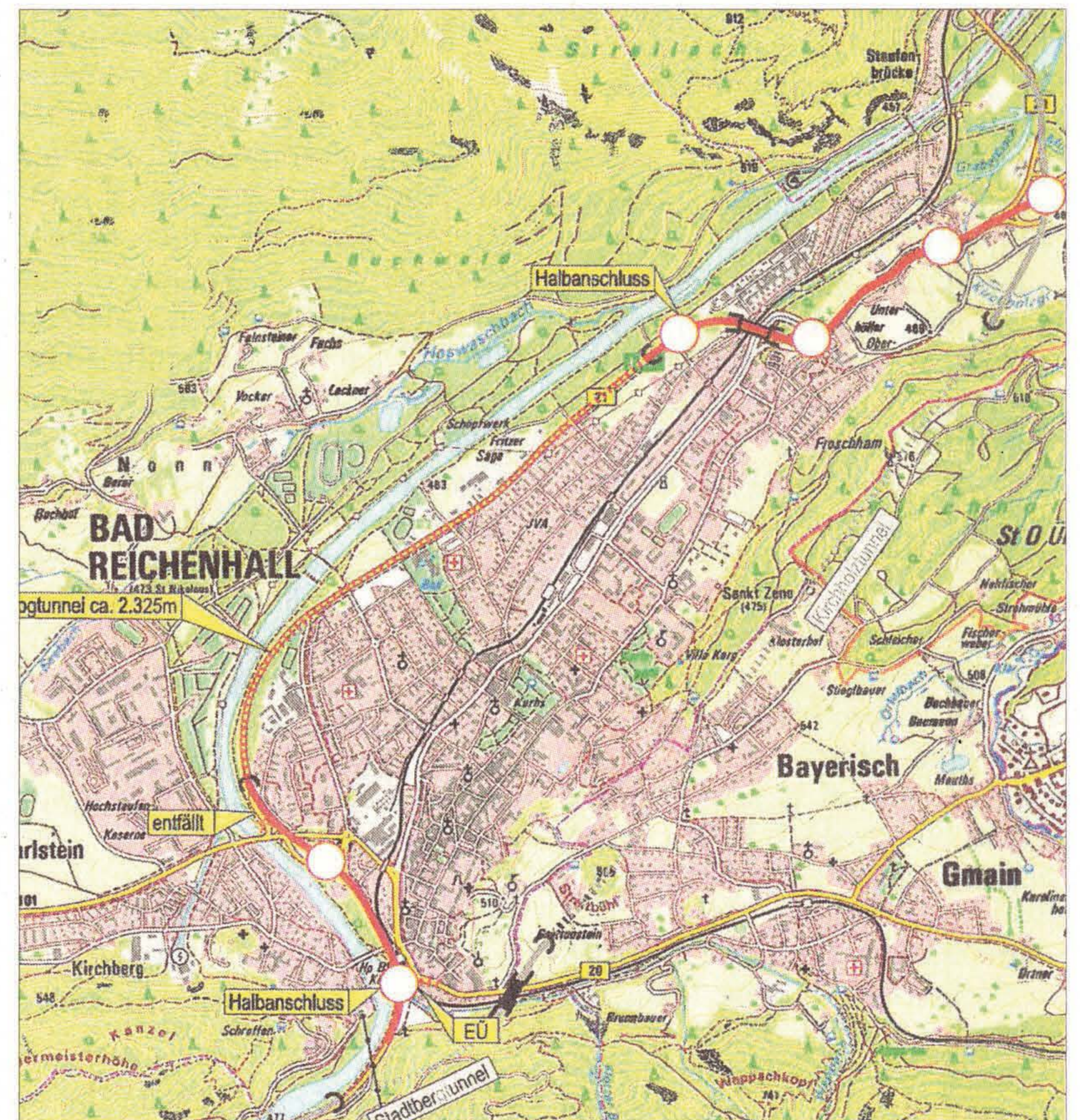
Alternative: Wo heute die Umgehungsstraße verläuft, soll ein Tunnel entstehen, wahlweise zwei- oder vierstreifig oder auf zwei Ebenen.
