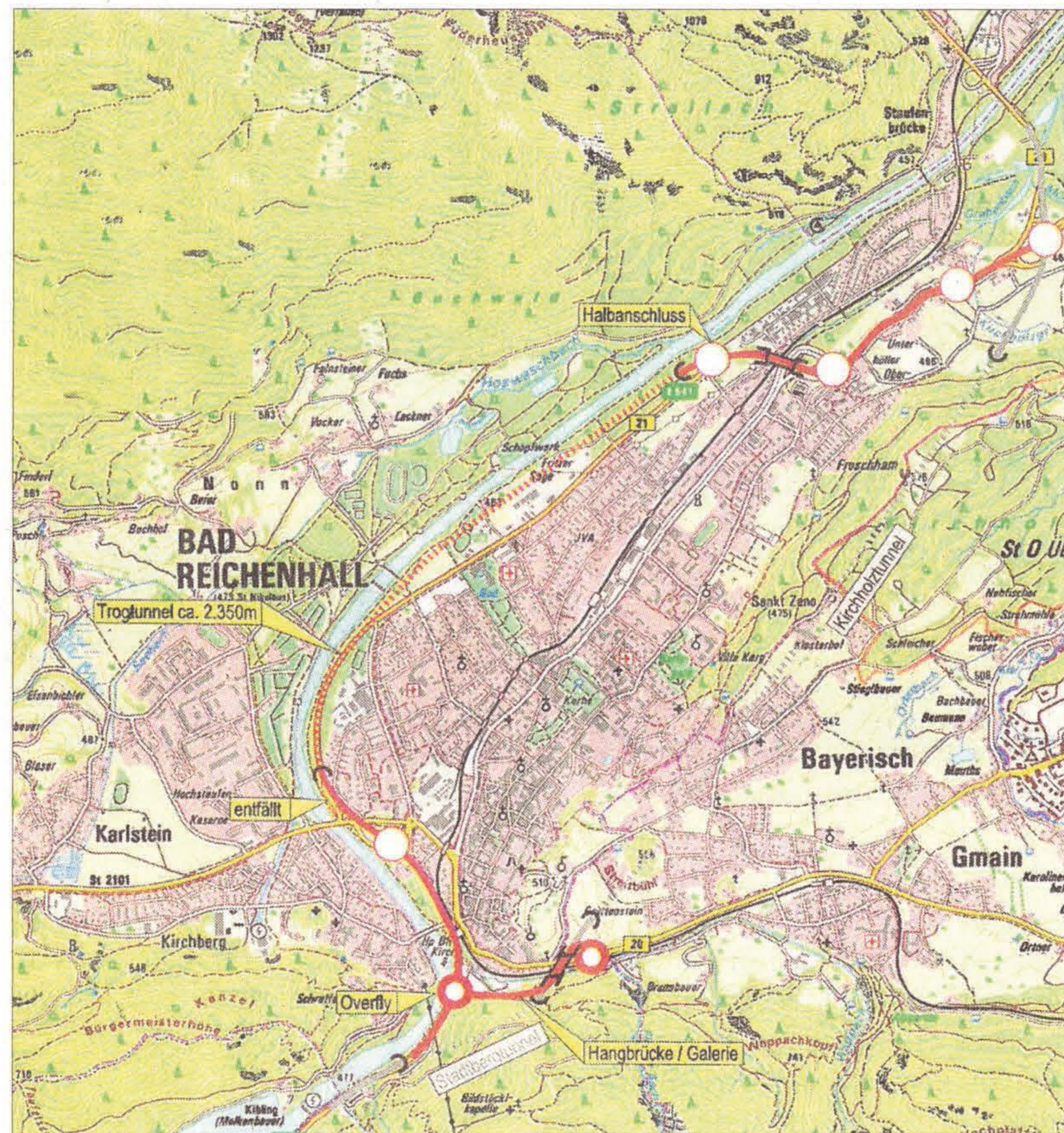
„Variante Max Aicher“: Der vierspurige Auentunnel verläuft parallel zur bestehenden Umgehungsstraße. – Fotos: Stadt Bad Reichenhall
