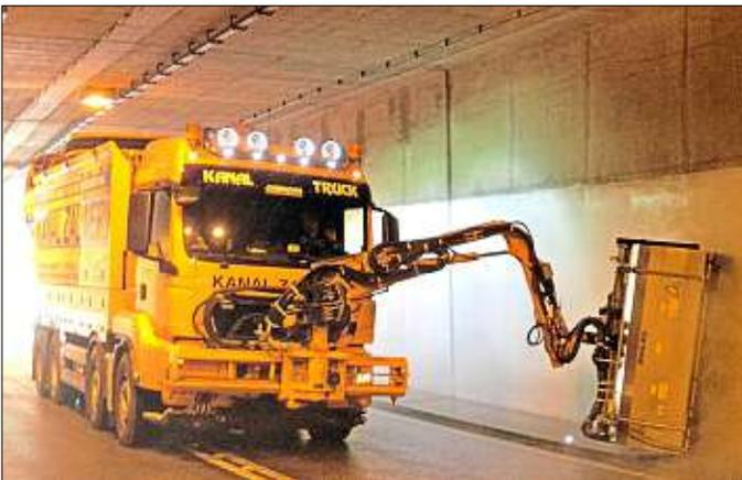
**Mit speziellen Fahrzeugen** werden die Innenwände des Ettendorfer Tunnels am Dienstag und Mittwoch gereinigt. – Foto: Bauamt
